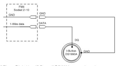
5 Figure Digital key "I-Button" DS1990A connection scheme
