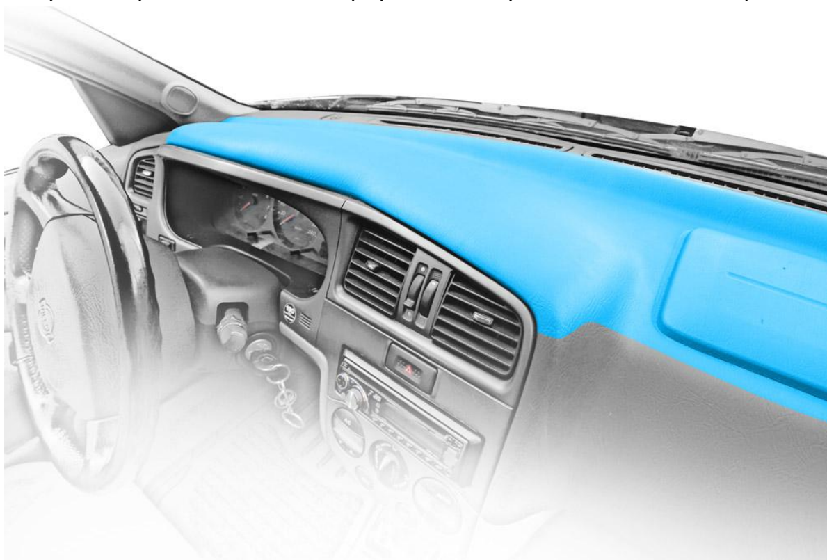
Рис. 9. Зона предпочтительного размещения GPS антенны.
